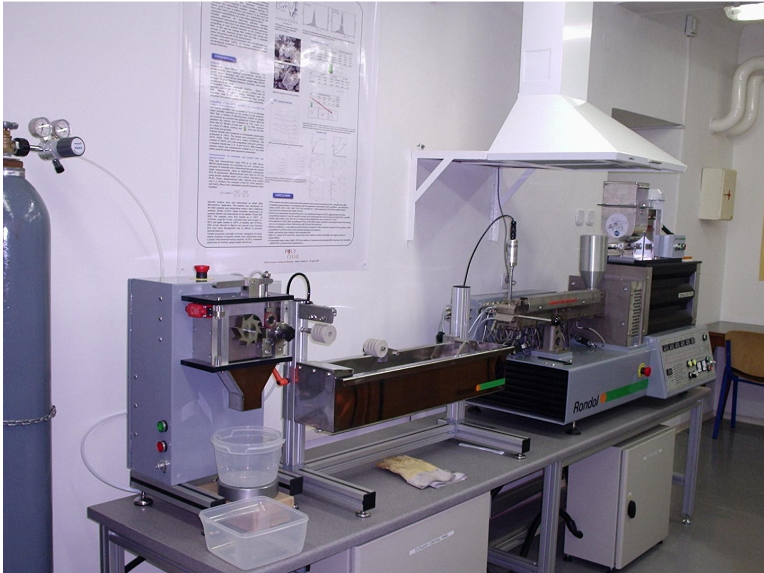
Laboratorijski dvopužni ekstruder, FKIT
