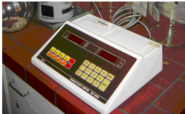
Slika 9. Mikroprocesorski laboratorijski konduktometar MA 5964 (Iskra Kranj, Slovenija) i ćelija za mjerenje vodljivosti
